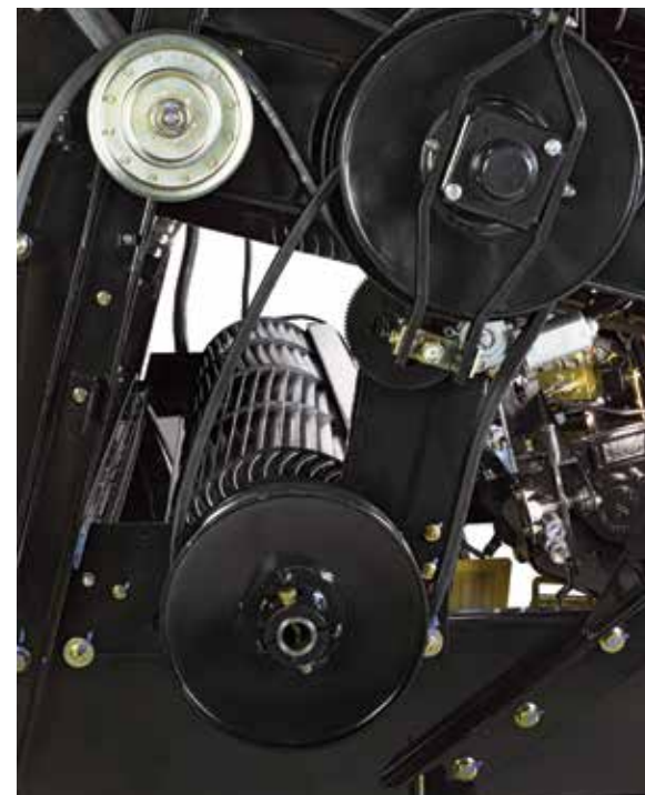
Sistema Cross Flow com captação de ar pela parte superior do ventilador
